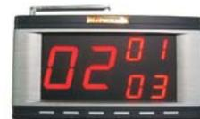
Pantalla inalámbrica Frecuencia: UHF Despliega 3 llamados
